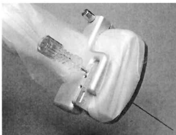
Fig. 3-6 Dispositivo di guida dell'ago fissato alla sonda e ago inserito
